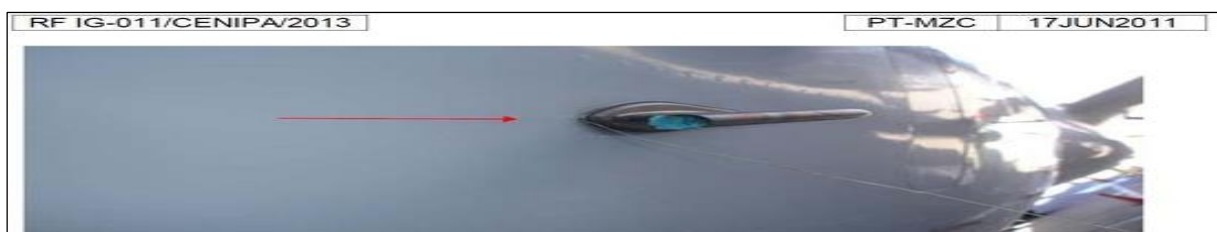
Figura 2 - Tubo de Pitot obstruído por plástico
